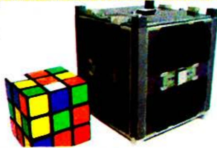
Наноспутники – массой до 10 кг, микроспутники – до 100 кг.
